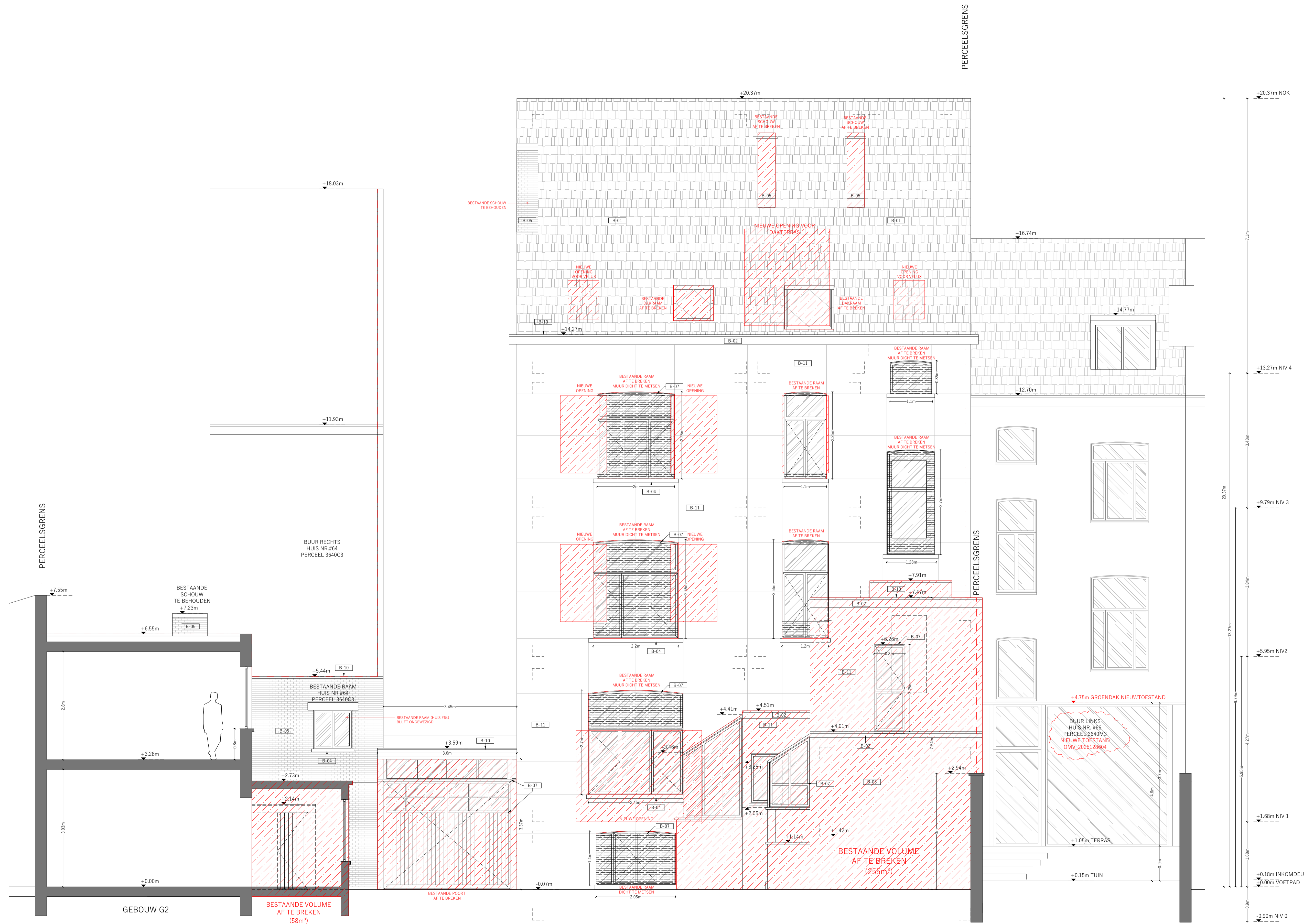
GEBOUW G1 | BESTAANDE TOESTAND | ACHTERGEVEL | SCHAAL 1:50
