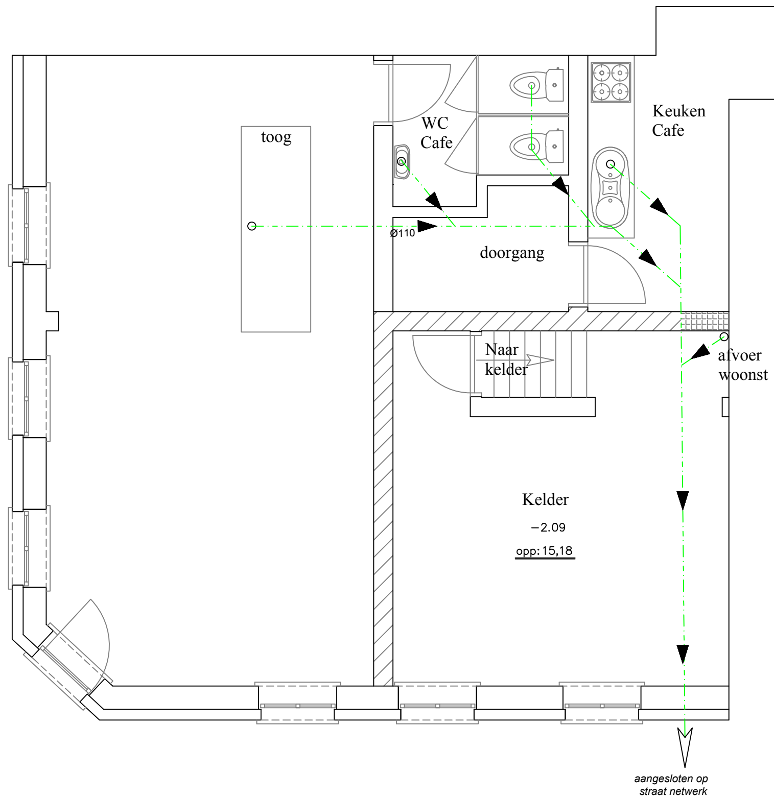
Riolerings- en kelderplan Bestaande toestand
