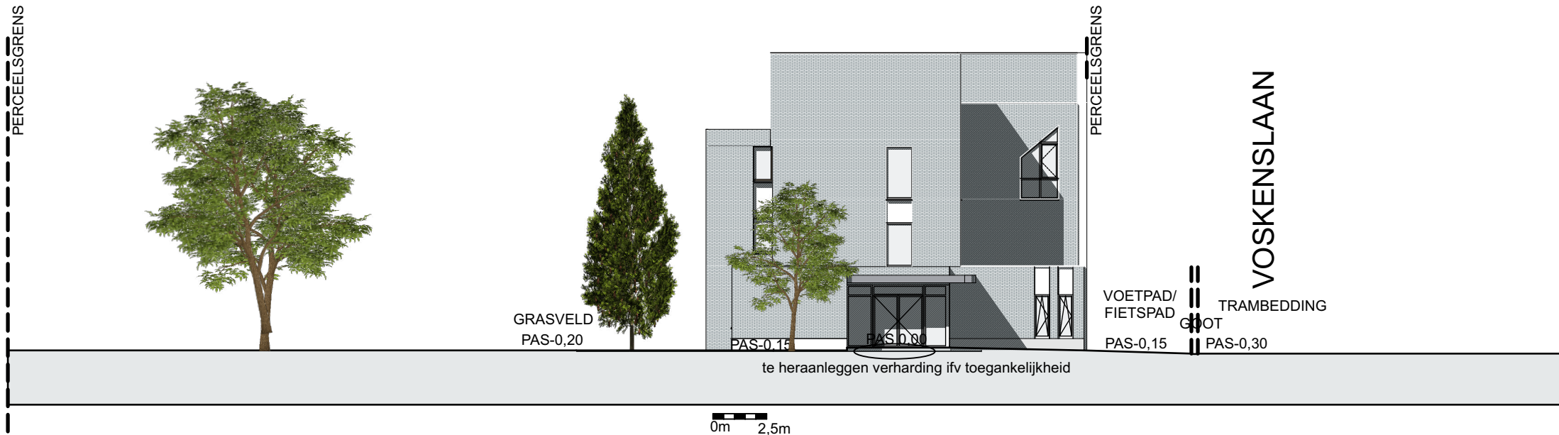
TERREINPROFIELSNEDE - NIEUWE TOESTAND schaal 1/250, maataanduiding in meter.
