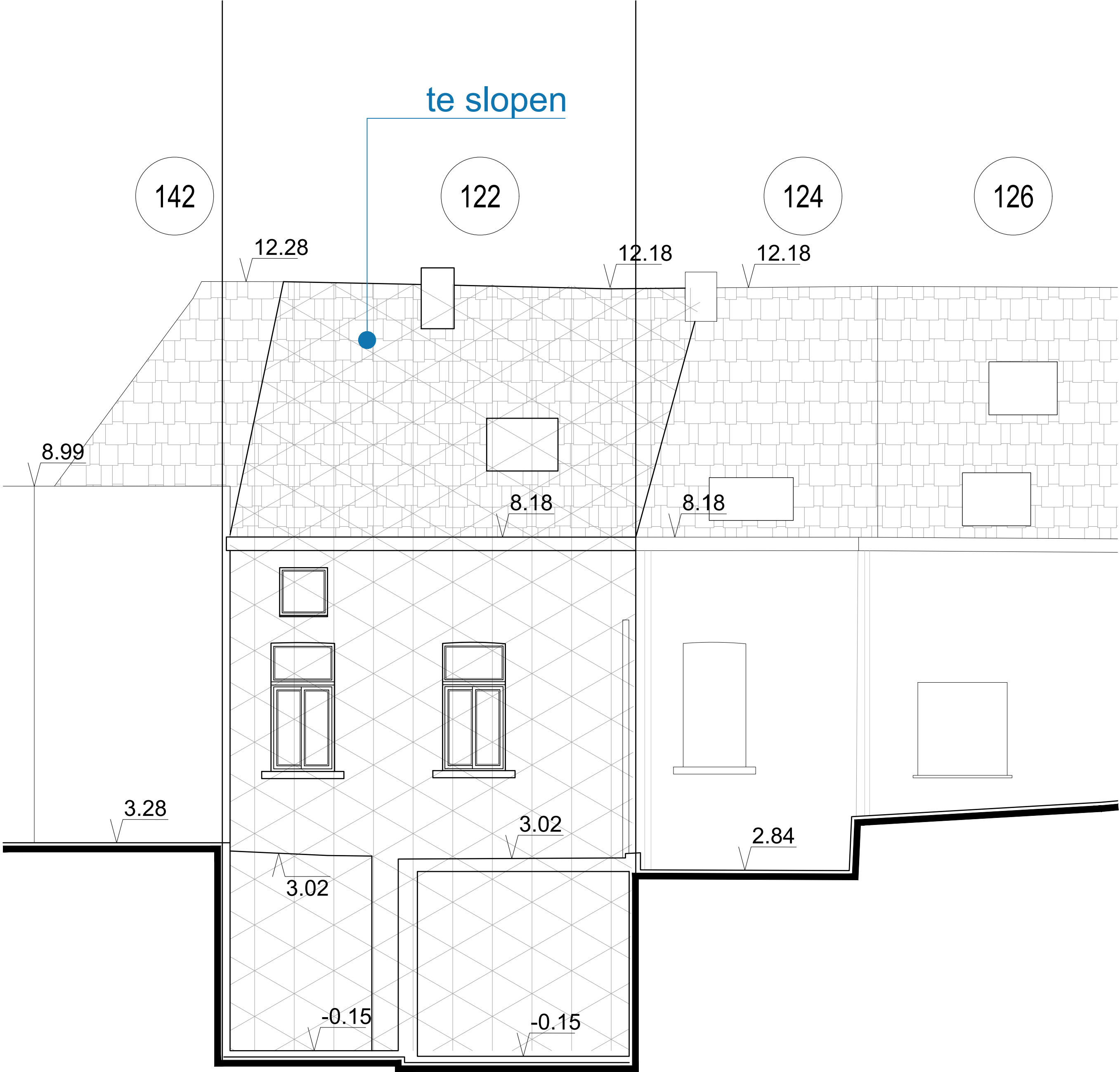
WONING - ACHTERGEVEL BESTAANDE TOESTAND - TE SLOPEN
