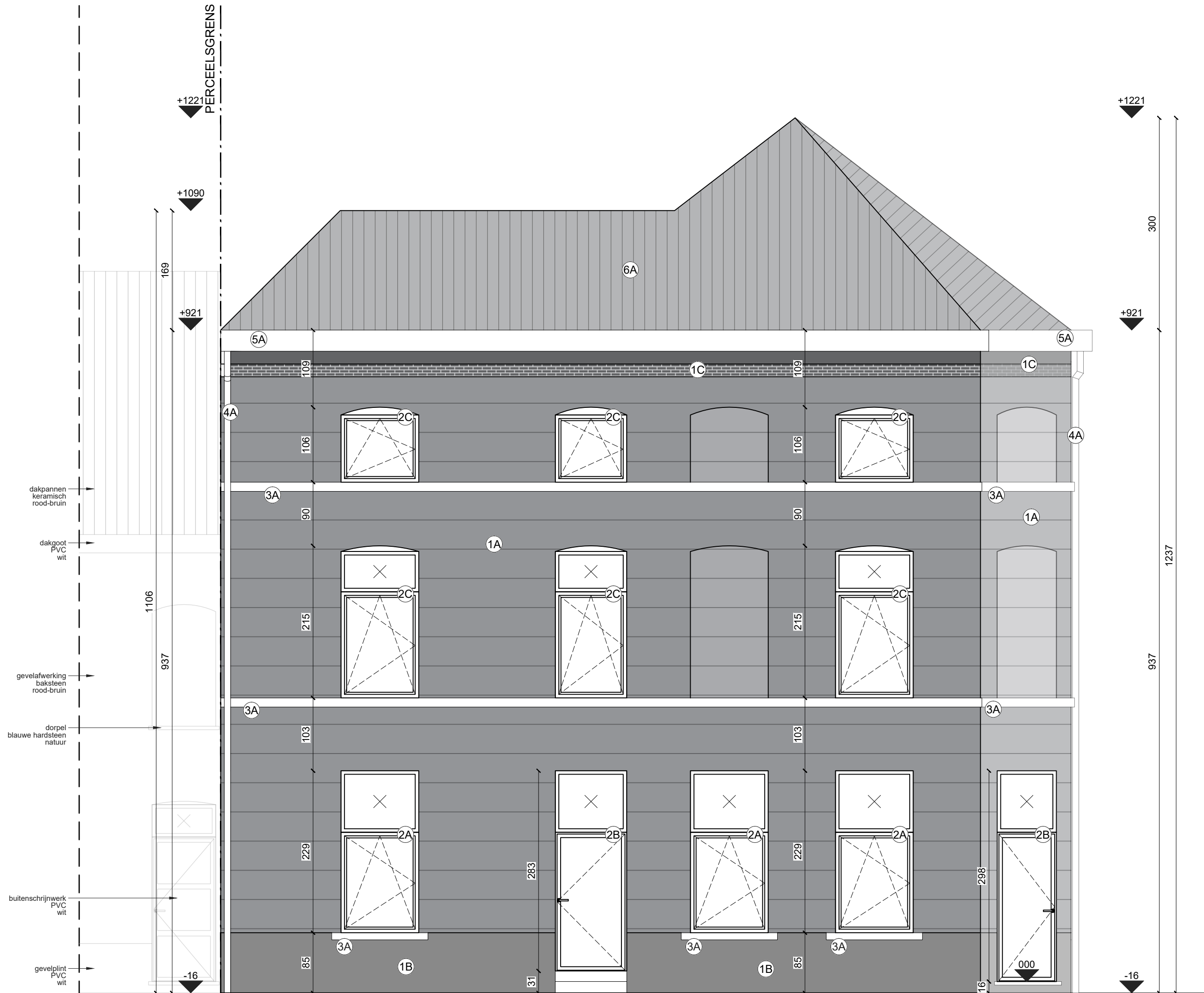
BESTAANDE TOESTAND: GEVEL LINKS schaal 1:50
