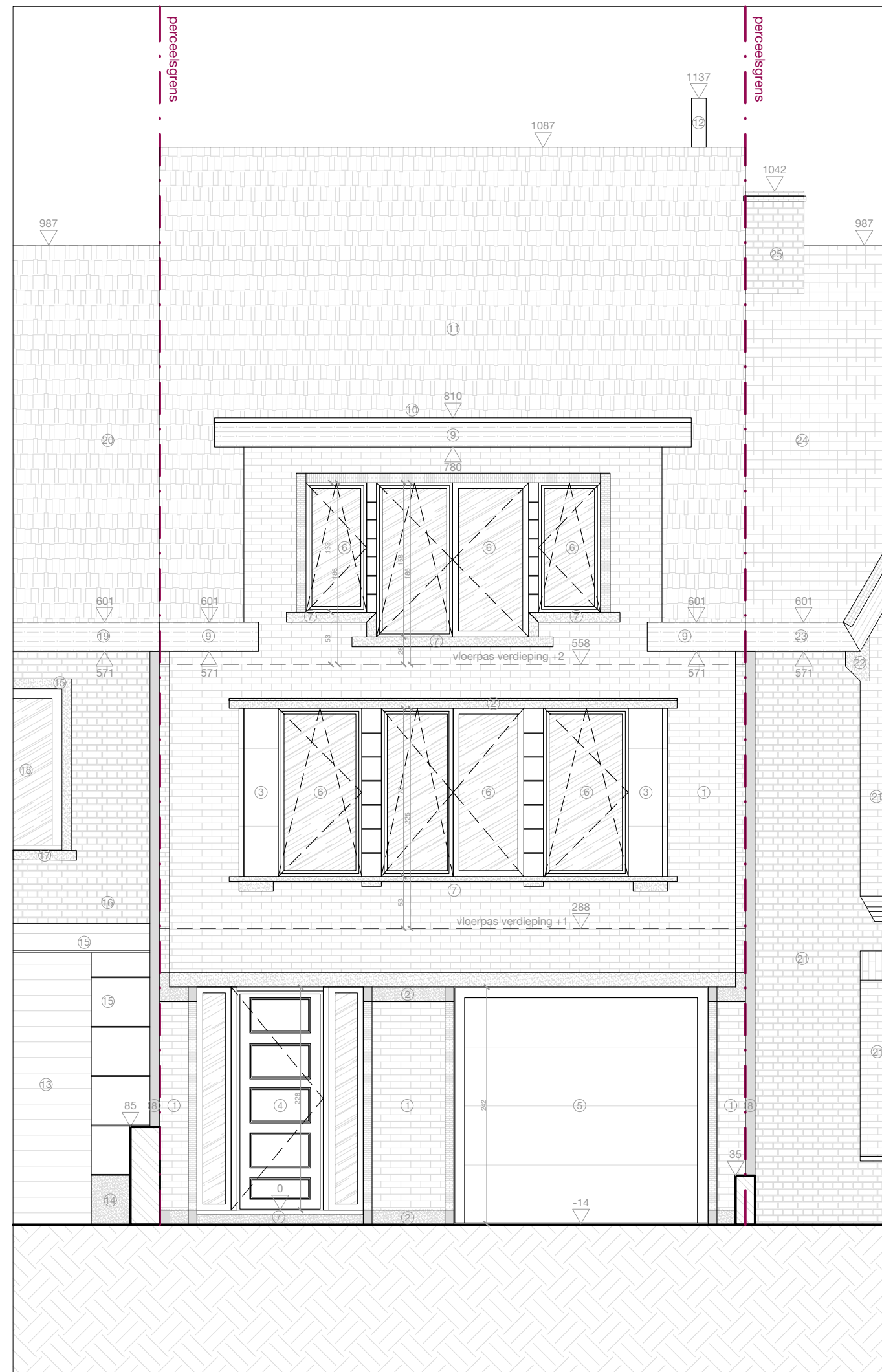
Aanzicht voorgevel- nieuwe situatie (ongewijzigd) 1:50
